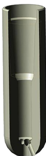
ИМ3-14.275.04-04 Насадка промывочная с 7-ю отверстиями. Ø 38
